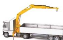
Grue de chargement montée derrière la cabine
