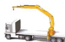
Grue de chargement montée en position centrale
