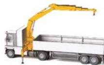
Grue de chargement montée derrière la cabine
