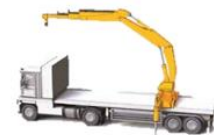
Grue de chargement montée en position centrale
