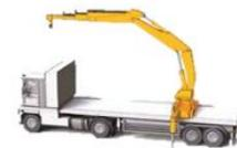
Grue de chargement montée en position centrale
