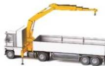
Grue de chargement montée derrière la cabine
