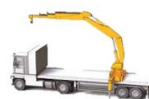
Grue de chargement montée en position centrale
