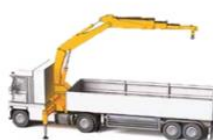
Grue de chargement montée derrière la cabine
